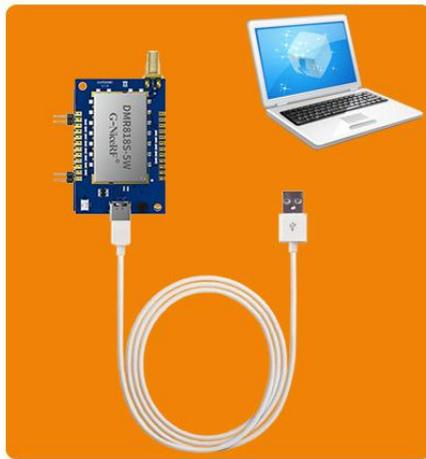
对讲模块USB配置接口连接示意图
